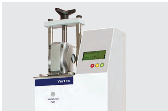
Figura 2 Aparati për injektimin e materialit termoplastik në mufël.
