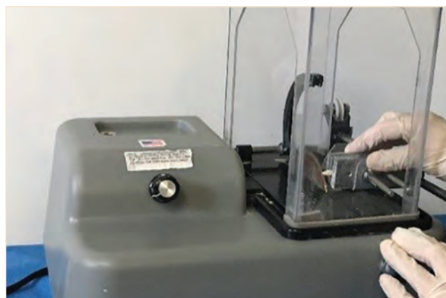
Figura 1 Prerja e dhëmbëve në kufirin smalt-cement me Smart Cut 4002
