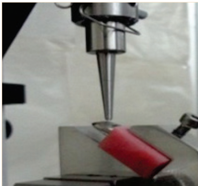
Figura 3 Aplikimi i ngarkesës statike në Makinë Testuese Universale.
