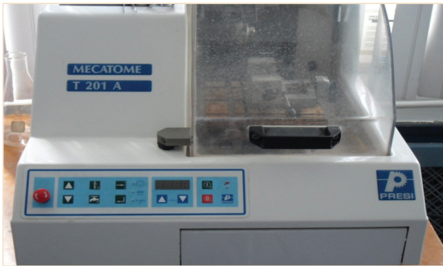
Figura 3 Mikrotomi për prerjen e mostrave.
