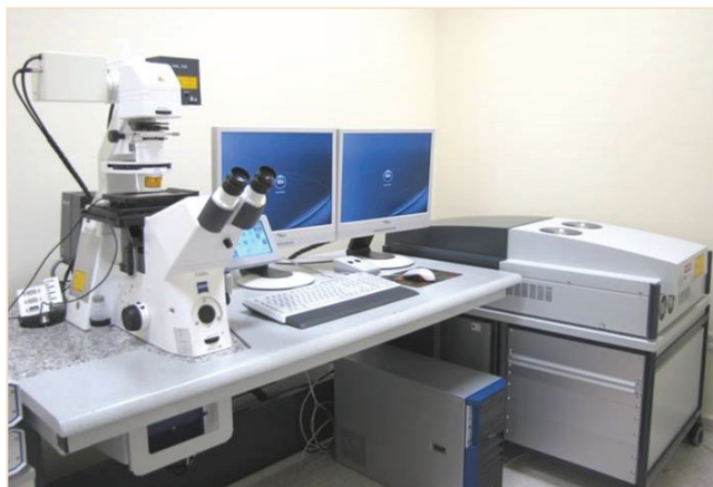
Figura 2 Mikroskopia konfokale laserike.
